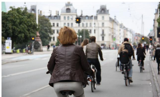
Fig. 8 : Une largeur suffisante permet aux cyclistes de rouler côte à côte et de se dépasser : ici, une piste cyclable unidirectionnelle de 3 m de large à Copenhague.
