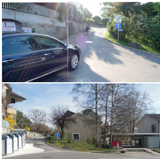
Fig. 11 : Comparaison « avant-après » : les conditions de visibilité sont meilleures, le chemin en haut à gauche est réservé aux piétons et aux cyclistes, et les barrières ralentissent les vélos.
