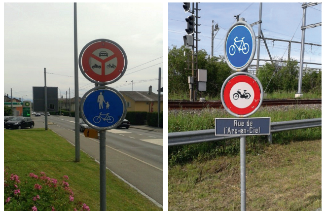
Fig. 15: Exemples de signalisation incohérente : le panneau bleu oblige l'utilisateur d'un VAE45 à emprunter l'itinéraire, alors que le panneau rouge lui interdit de rouler le moteur allumé.
