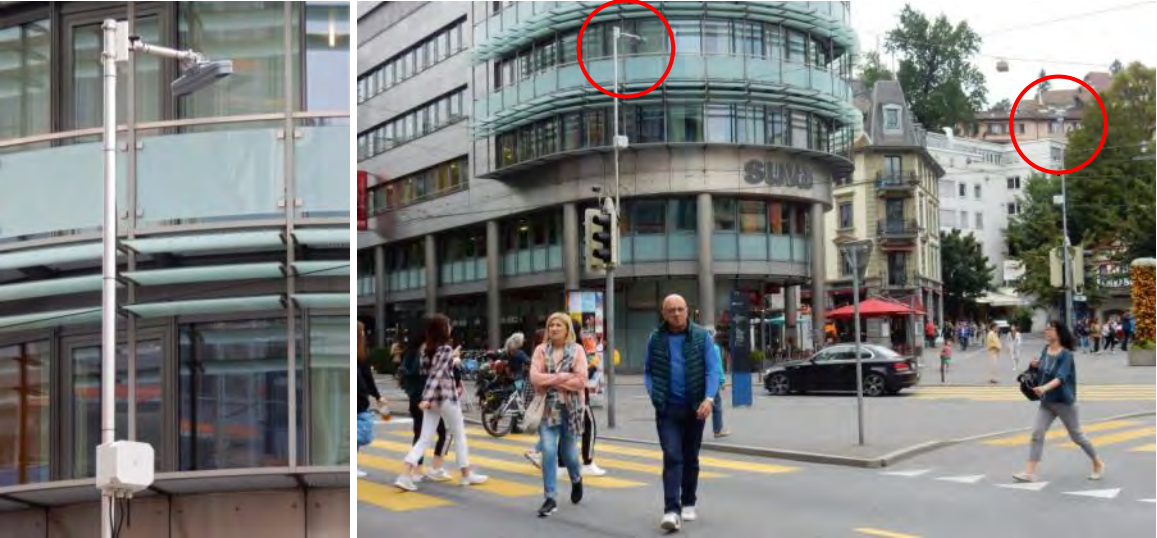
Abbildung 47: Fotos der 3-D Kamera PeCo SCX-L-Outdoor von LASE am Löwenplatz
