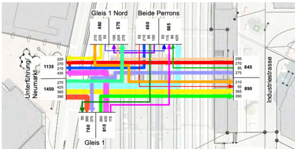
Abb. 18 Verkehrsflussdiagramm Personenunterführung Nord, Abendspitzenstunde werktags von 17-18 Uhr, Angaben in Personen/Stunde
