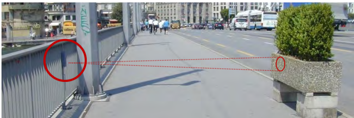
Abbildung 18: Foto der Zählinstallation auf der Seebrücke 2012 mit einem Passiv-Infrarotsensor (Pyrobox) der Firma EcoCounter (analoge Installation 2017)
